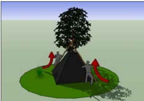
Wenn du nun mit einer Helferin, einem Helfer die beiden Stangen wie im Bild zusammenschiebst und dadurch auch nach oben drückst, richtet sich die Kohte wie von selbst auf. Schiebe die beiden Stangen soweit zur Kohte hin, bis du die richtige Spannung erreichst. Bleibt deine Kohte zu lummerig, dann sind vielleicht die Stangen zu kurz, oder das Seil zum Kohtenkreuz ist zu lang.
